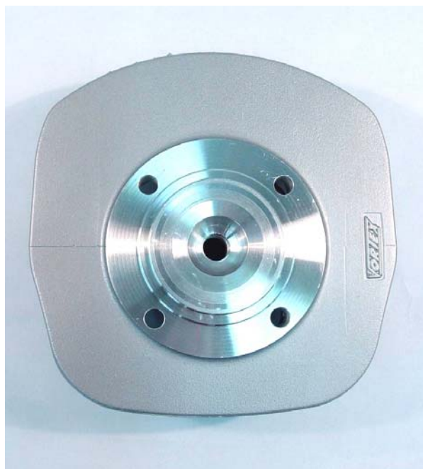
FOTO DELLA CAMERA DI COMBUSTIONE
